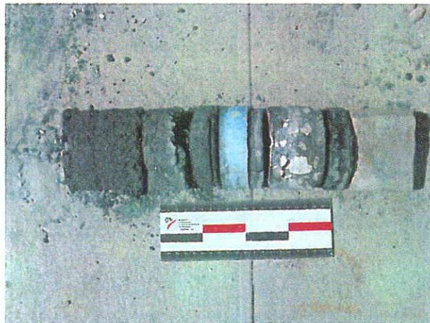
> Figura 2 – Carote extraída num pavimento constituído por pequenas abóbadas de tijolo cerâmico e perfis metálicos, sendo visíveis as camadas adicionadas ao longo do tempo.
