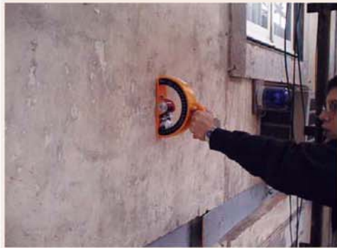
Caracterização mecânica com esclerómetro de pêndulo.
