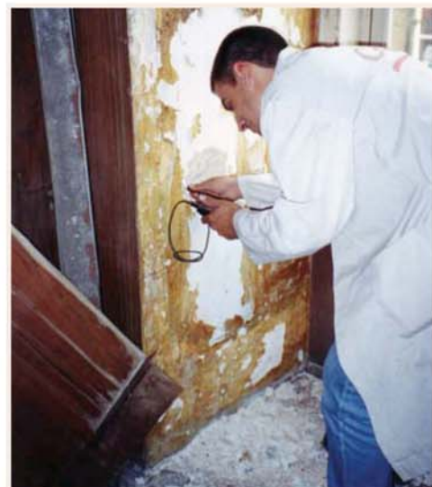
Medição da humidade numa parede.
