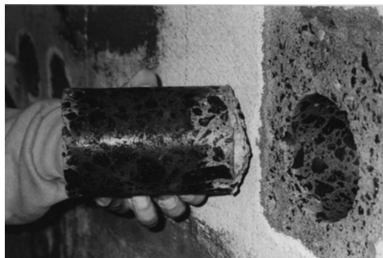
Figura 1 - Malha de armaduras detectada, malha para medição do potencial eléctrico das armaduras e ensaios esclerométricos. Figura 2 - Ensaio para determinação da profundidade de carbonatação numa carote.
