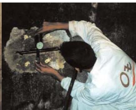
*Medição das deformações da alvenaria durante a determinação do estado de tensão.*
