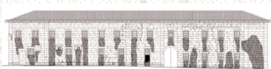
Fig.3 - Mapeamento das anomalias detectadas no alçado lateral direito (Sul).
